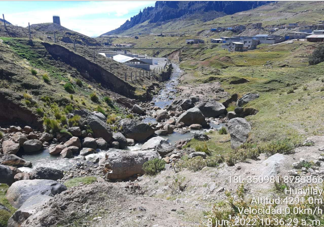
Fotografía 3: Peligro de deslizamiento ambas margenes del talud del rio San Jose, en el sector Huayllay, que afectaria el PTAR de Huayllay.
